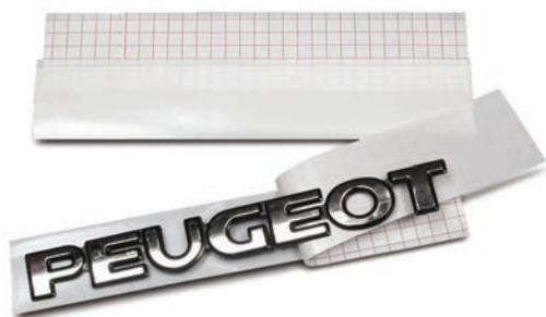
Biadesivo a contatto per l'incollaggio di emblemi e loghi dei veicoli. Resistenza termica dell'adesivo da -30°C a +180°C. Temperatura di applicazione: da +15°C a +35°C.
