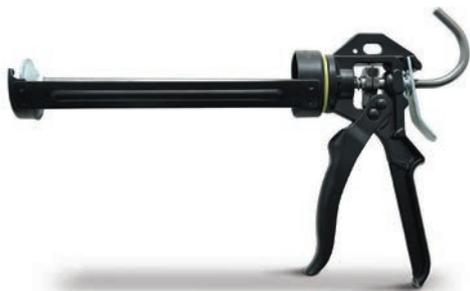
Pistola manuale professionale totalmente in metallo per l'estrusione di sigillanti monocomponenti a media-alta viscosità in cartuccia da 290/310 ml. Culla rotante. Forza di spinta: 250 Kgf. Asta di spinta: in acciaio temprato. Frizione: calibrata in acciaio temprato. Peso: 0,850 Kg.
