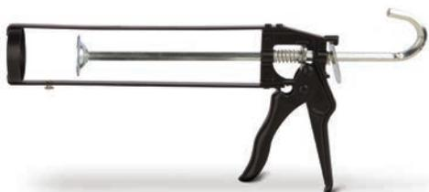
Pistola manuale in metallo per l'estrusione di siliconi e sigillanti monocomponenti a bassa viscosità in cartuccia da 290/310 ml. Forza di spinta: 120 Kgf. Asta di spinta: in acciaio temprato a sezione esagonale. Peso: 0,520 Kg.
