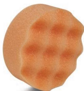
Mini tampone bugnato arancio a media densità e durezza, adatto per la lucidatura delle verniciature con paste abrasive di diverso potere mordente. Ideale per la lucidatura di aree localizzate e zone poco accessibili. Da utilizzare con lucidatrici a giri variabili. Attacco grip.
